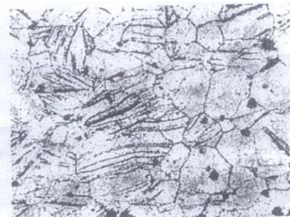
Slika 999 250:1 Isto kao na slici 998, ali plastično deformisan pod malim pritiskom. Stvaranje dvojnih kristala.
