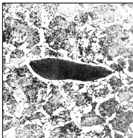
Sl.1. Uključak MnS u otkivku čelika sa 0,35%C
