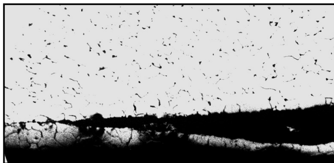
Sl.15. Mikrostruktura pregorjelog čelika
