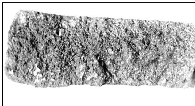
Sl.8. Prijelom nastao u hladnom stanju (neoksidiran)
